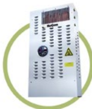
РЕГЕНЕРАТИВНЫЙ ПРИВОД REGEN Сохраняет энергию, которая расходуется во время торможения лифта, и направляет её в электрическую сеть здания
