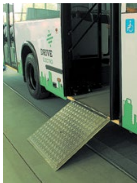
Подъёмное оборудование электробуса
