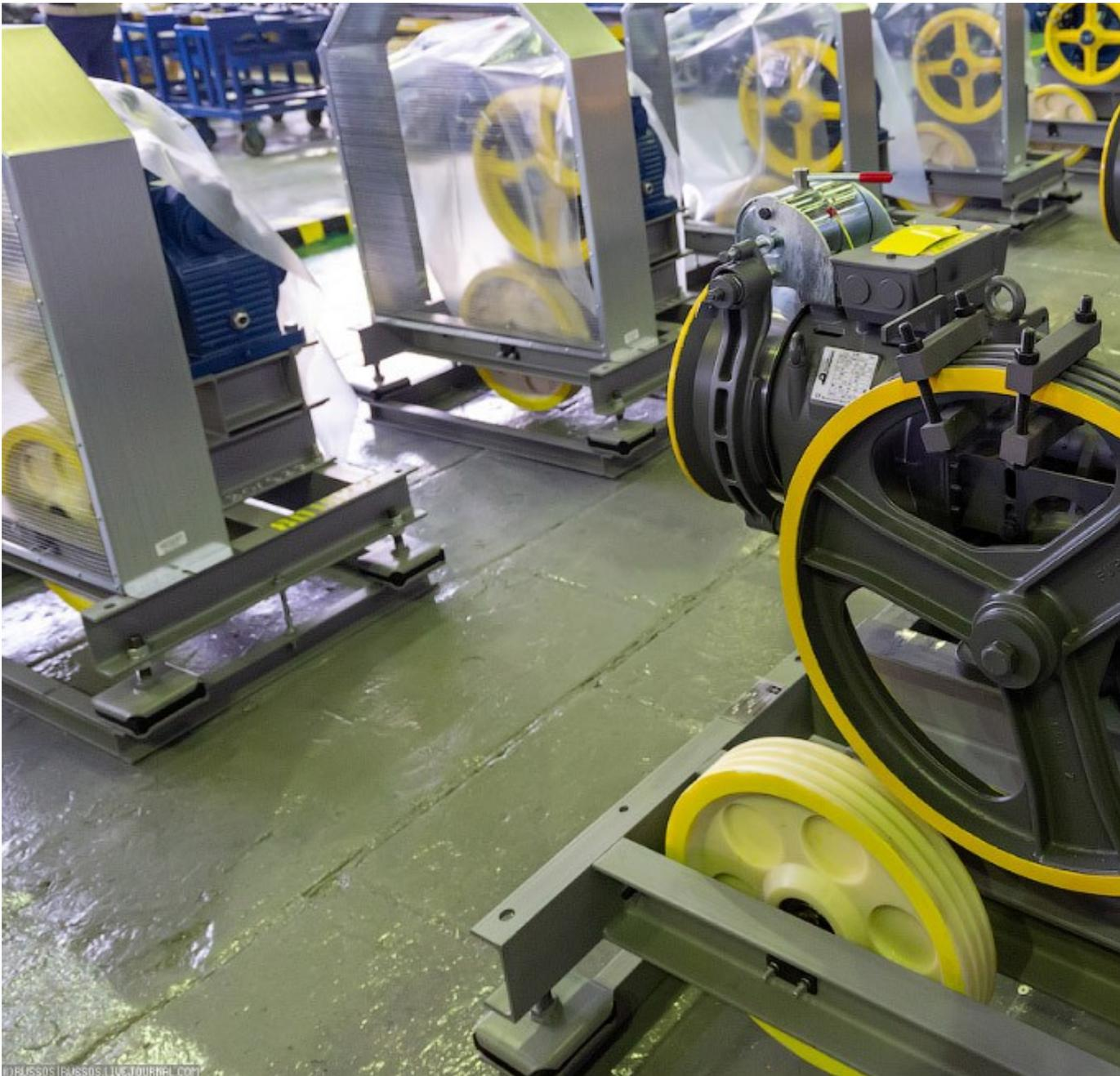
Привод и редуктор для лифта без машинного отделения. Привод монтируется в шахте. Выгодно для строителей, но очень сложно для эксплуатации.
