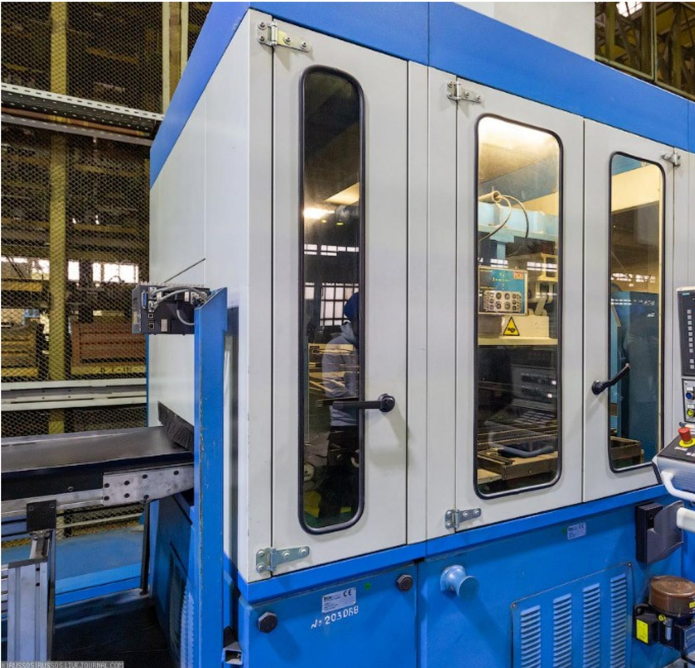
Далее они поступают на многоголовочную порталную сварочную машину, где производится контактная точечная сварка дверей кабины и шахт лифта.
