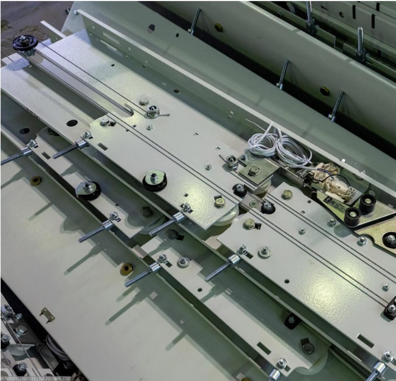
Стенд для проверки дверей. Оказывается в каждой двери стоит груз, который обеспечивает автозаккрытие дверей, если пропадет напряжение в приводе. На стенде так же проверяют работу концевых выключателей.
