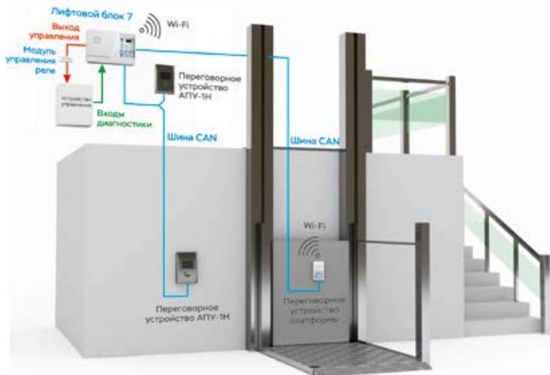
Рисунок 2. Пример монтажа оборудования на вертикальной инвалидной платформе.
