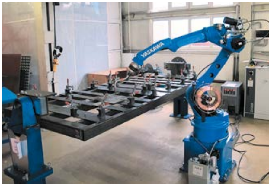
Полностью роботизированный узел сварки
